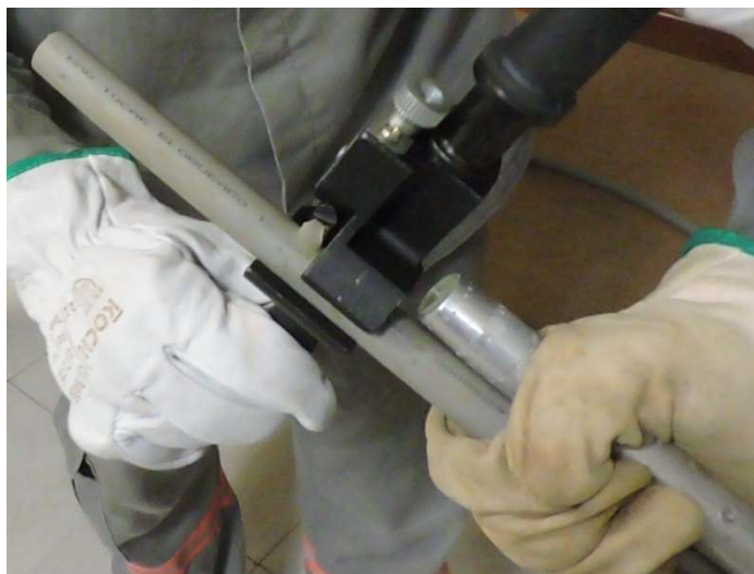
Figura 8 – Retirando a cobertura – início
