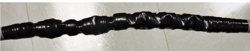
Figura 18 – Emenda com fita isolante pronta
